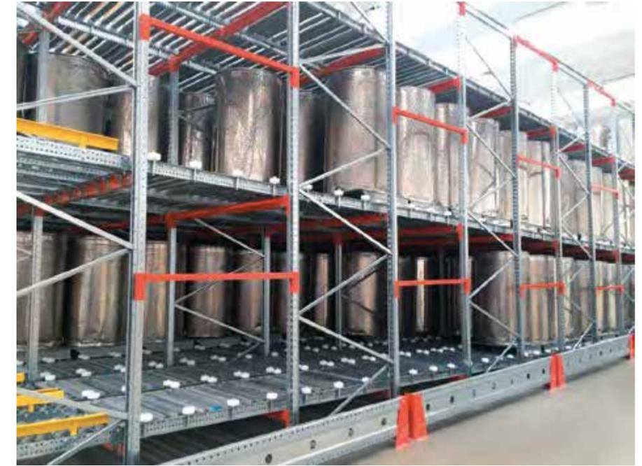
Le scaffalature dinamiche per lo stoccaggio di prodotti pallettizzati sono strutture compatte dotate di rulliere disposte in leggera pendenza per consentire il movimento dei pallet. I pallet vengono inseriti nella parte più alta delle rulliere e si muovono per gravità e a velocità controllata fino a giungere all'estremità opposta pronti per essere estratti.
