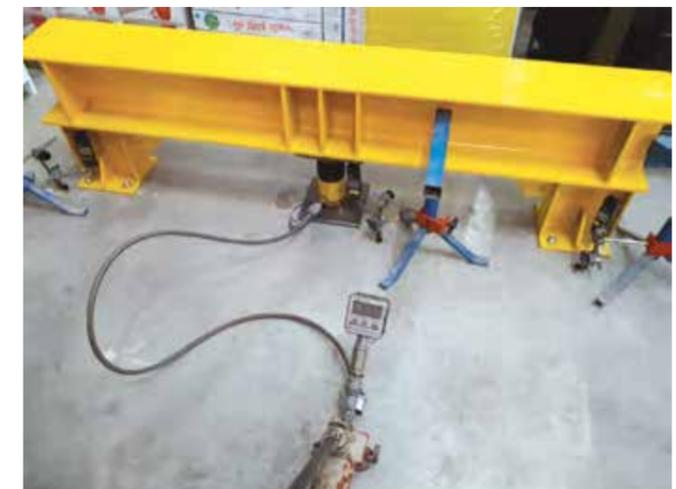
Prova di resistenza a trazione e compressione piastra di base scaffalatura
