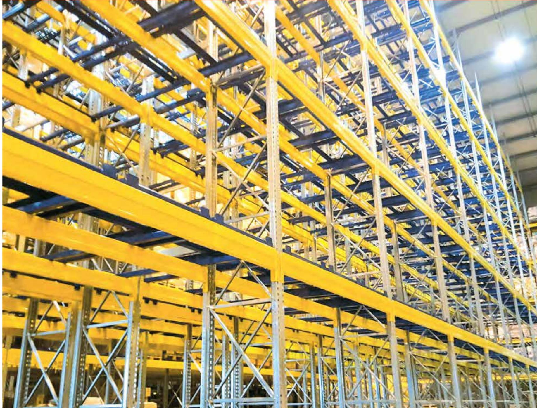
La scaffalature Push-back è un sistema di stoccaggio ad accumulo che consente di immagazzinare fino a quattro pallet in profondità per livello.
